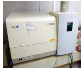
ICP発光分析装置 有害重金属の分析
