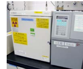
ガスクロマトグラフ ●GC ECD(電子捕獲型)検出器 アルキル水銀、PCBの分析等 ●GC FPD(炎光光度)検出器 有機リン化合物の分析等
