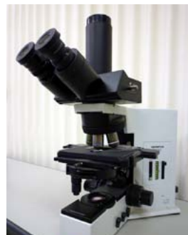
位相差顕微鏡 アスベストの計測
