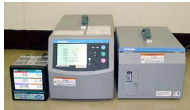
排ガス連続測定器 NOx、SOx、CO、CO 2 、O 2 の5成分同時測定
