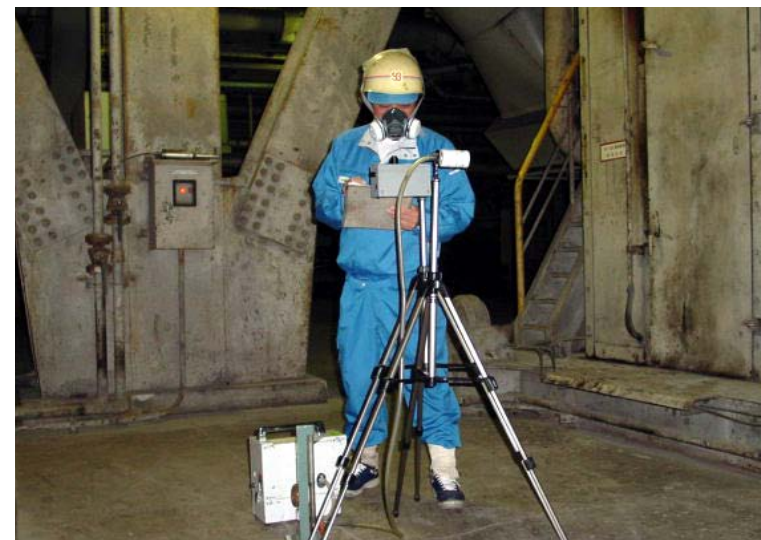
鉱物性粉じん作業場での粉じん測定作業の様子
