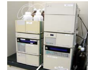
HPLC(高速液体クロマトグラフ) シマジン、チウラム、チオベンカルブ (農薬関係)の分析等
